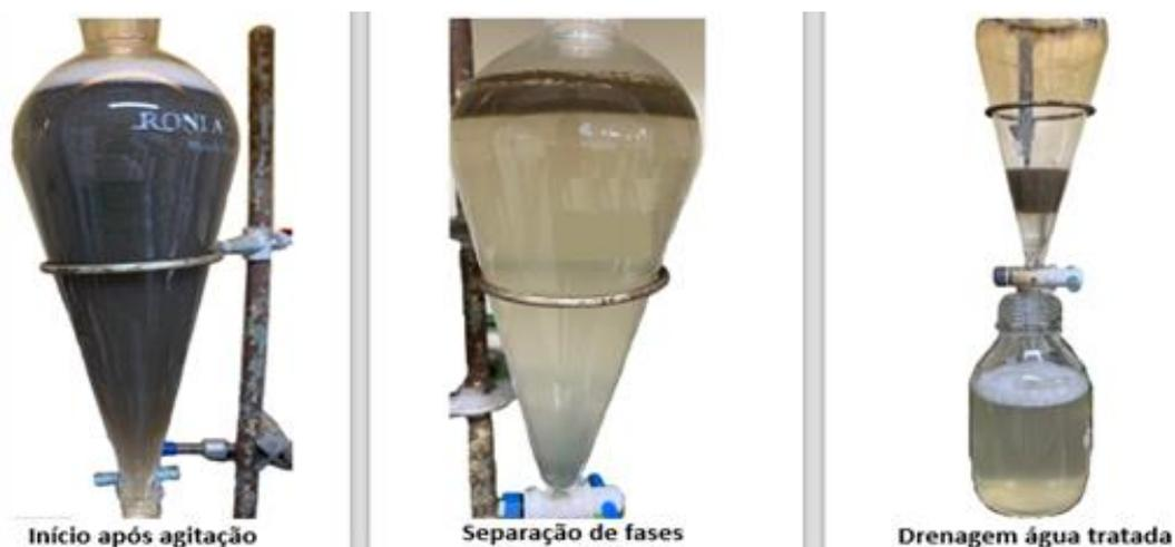
Figura 2 – Exemplo das etapas após agitação do funil, separação de fases e drenagem da água tratada.
