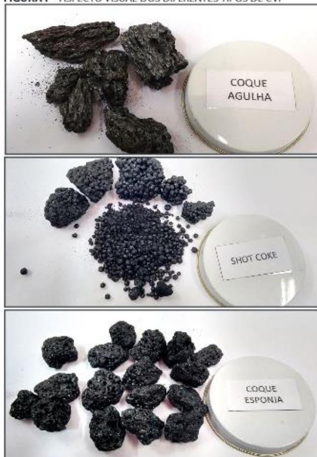
enxofre, resinas e metais. Normalmente a carga utilizada é o óleo decantado da unidade de craqueamento catalítico (FCC). Possui uma estrutura cristalina com a forma de agulhas e poros direcionais, assim como baixo coeficiente de expansão térmica e elevadas condutividades elétrica e térmica. Devido às suas propriedades, é utilizado na fabricação de eletrodos de grafite empregados na indústria do aço elétrico.
