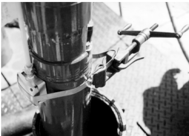
Figura 4 - Fixação dos acelerômetros no corpo do conjunto de BCS
