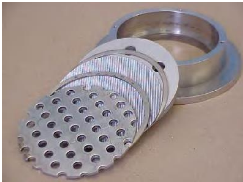
Figura 8 – Exemplo de composição de corpo de prova para teste de erosão. Todas as camadas da tela devem estar representadas.
