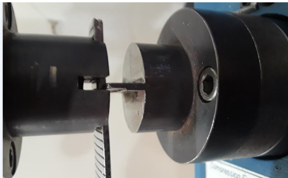
Figura 6 – Teste de resistência da solda entre o arame e a longarina.
